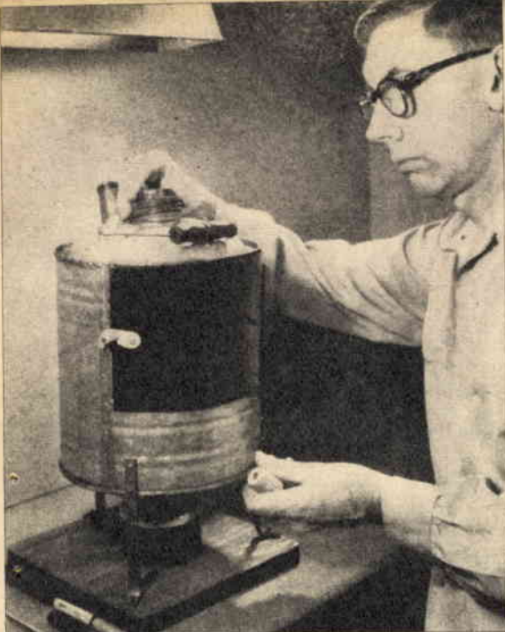
Fig.1 - Un vecchio bidone, opportunamente lavorato, e una «candela» elettrica costituiscono il piccolo forno adatto per cuocere dei lavoretti in ceramica o per ottenere una verniciatura a fuoco.
